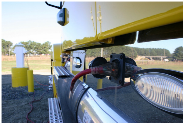
Afbeelding 13: koeling via walstroom
